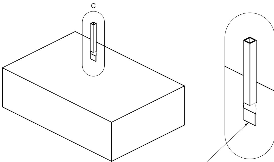
Fourreau acier galva 20x20x1.5 écrasé - Il doit être noyé dans le béton
